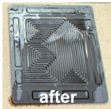
Exemple d'application d'un séparateur pour pile à combustible
