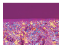
Structure de la couche composite SiC/C
