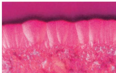
La estructura con forma de columna de la capa de carbono pirolítico significa que la estructura es extremadamente fina.
