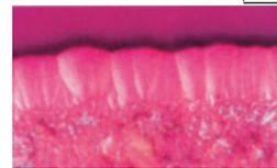
La estructura con forma de columna de la capa de carbono pirolítico significa que la estructura es extremadamente fina.
