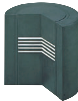
Moule à presse chaude (modèle de coupe)
